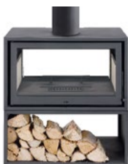
Salamandra SV 9.4 Z S/ vent. 2 portas 934 x 850 x 600 mm Saída fumo Ø 200 mm Rendimento 75%
