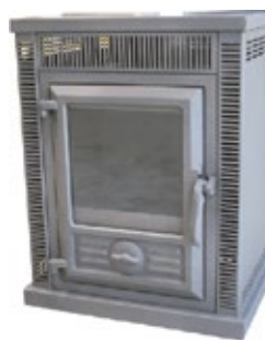
Salamandra SV 6.1 Z Sem ventilação 620 x 470 x 340 mm Saída fumo Ø 125 mm Rendimento 70%
