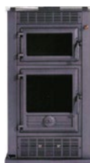
Salamandra CV 5.7 Z Com ventilação e forno 1040 x 594 x 502 mm Saída fumo Ø 150 mm Rendimento 77%
