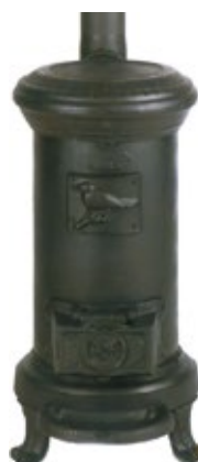
Salamandra Nr. 5 Saída para trás L 370 x A 710 x P 600 mm Potência calorífica 5000 Kcal/h Peso 63 Kg Saída fumo Ø 100 mm
