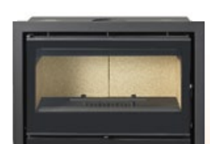
Recuperador CV 14 Z C/ventilação Caixa 590 x 827 x 435 mm Aro 680 x 900 x 450 mm Saída fumo Ø 180 mm
