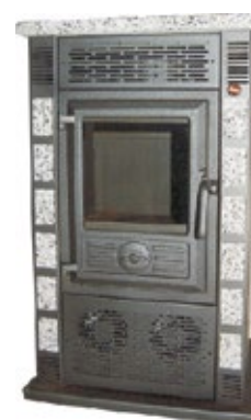
Salamandra CV 5.2 Z Com ventilação 890 x 540 x 410 mm Saída fumo Ø 150 mm Rendimento 76%
